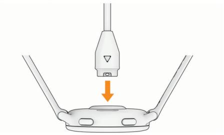
2 Conecte a outra extremidade do cabo à porta de carregamento USB.O relógio exibe o nível atual de carga da bateria.
