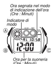
Quando la suoneria quotidiana è attivata, il segnale acustico della suoneria suona quando viene raggiunta l'ora fissata per la suoneria. È possibile attivare anche il segnale orario di ora esatta che fa suonare l'orologio due volte ogni ora allo scoccare dell'ora.
